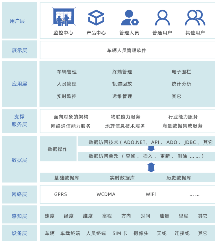
图 3. 车辆人员监控平台架构示意图
