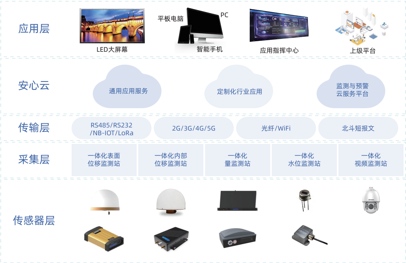
图 3 . 监测发布 WEB 软件架构示意图
