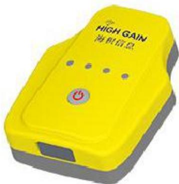
海积北斗巡检终端 RY101 是一款专为人员巡检设计的小型化便携式用户终端设备，终端支持 BDS、GPS、GLONASS 等卫星导航系统的信号，支持伪距差分 and 载波相位差分定位功能，在外部差分数据链路可靠环境下，可达厘米级的水平定位精度。RY101 可通过蓝牙、网络外接各类智能终端。
