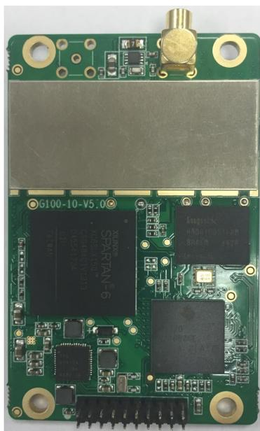
G100 OEM 板卡是上海海积信息科技股份有限公司自行研制开发的一款可接收 GPS L1/L2 和 BD-2 B1/B2 的双模四频高精度测量型产品，它具有高精度 RTK 定位、高质量原始观测量采集等特点。G100 可广泛应用于地面 CORS 站网建设、火灾地震抢险救灾、林业巡护和监控、地壳形变监测、山体滑坡监测、大气监测和电离层监测、土方施工测量、大型机械控制、精准农业、驾校车辆管理和教习、智慧交通系统建设等，能够为电力、电信、国防、交通等部门提供高质量服务。
