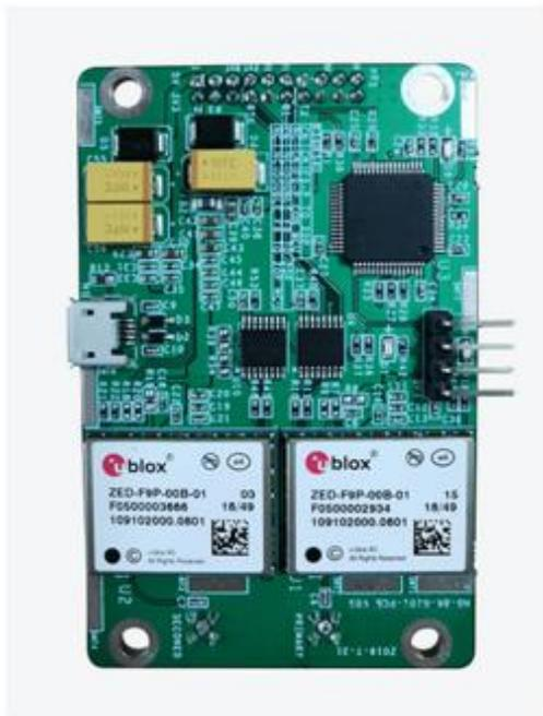
HG-BK-G201 板卡是上海海积信息科技股份有限公司研制的一款高精度定位定向产品，该板卡集成两块 UBLOX 公司推出的 F9 系列高精度模块，其中一块用作 BASE 基站，另外一块用作 ROVER 移动站，可接收 GPS L1/L2、BD-2 B1/B2、GLONASS L1 L2、GALILEO E1 E5、SBAS L1/L2 等信号，它具有高频率高精度 RTK 定位、高精度姿态测量、高质量原始观测量采集等特点。HG-BK-G201 板卡的硬件尺寸、接口、数据指令与国内外主流板卡兼容。
